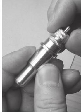
2) Настройте вылет ножа при помощи вращения гайки на держателе ножа, затем затяните гайку
