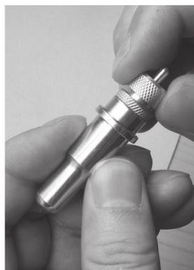
2) Настройте вылет ножа при помощи вращения гайки на держателе ножа «Adjustment depth knobs», затем затяните гайку
